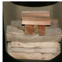
Breiter Feuerraum mit wenig Tiefe: Längsseite nach vorne
