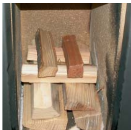
Schmaler Feuerraum: Holzscheiter mit Stirnseite nach vorne einlegen
